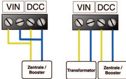
Der eingangsseitige Anschluss des Dekoders erfolgt gemäß obenstehender Abbildungen. Der Dekoder kann sowohl aus dem Gleissignal gespeist werden, als auch über einen separaten Trafo mit Strom versorgt werden.
